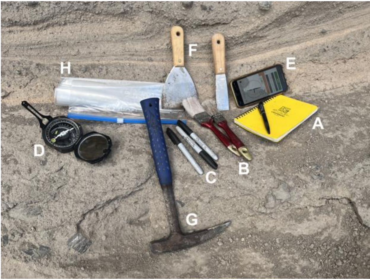
Figura 7: Equipo esencial para el muestreo paleomagnético de depósitos piroclásticos: [A] Libreta de campo, [B] cepillos o brochas de tamaños variados para limpiar las muestras de roca antes de etiquetarlas, [C] marcadores permanentes para etiquetar, [D] ejemplo de una brújula geológica con clinómetro para orientar muestras, [E] ejemplo de un aplicación móvil de brújula-clinómetro que también se puede utilizar para orientar muestras, [F] espátulas metálicas de tamaños variados para limpiar el afloramiento y las muestras, [G] martillo/pica geológica para limpiar el área alrededor de la muestra y extraer la muestra del afloramiento, [H] bolsas de tela o plástico para organizar las muestras orientadas.
