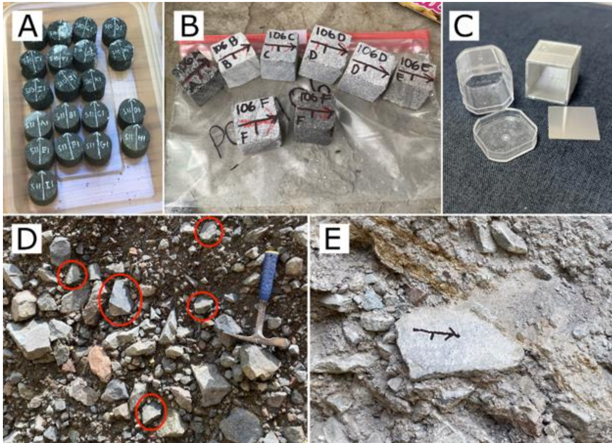
Figura 6: Fotografías de las características más importantes de muestras y especímenes paleomagnéticos. [A] ejemplo de especímenes cilíndricos de roca de diámetro de 25 mm y espesor de 25 mm, [B]
